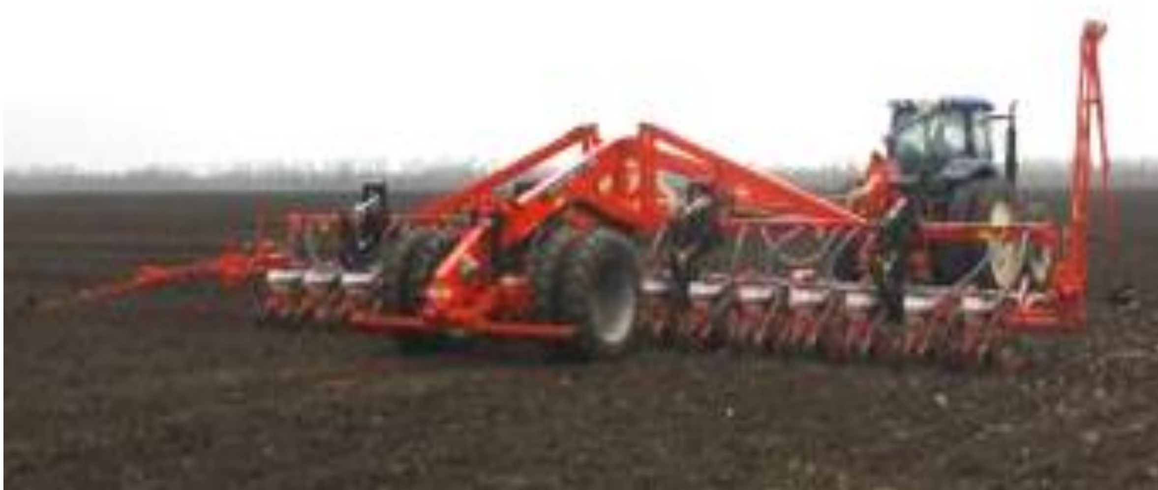
New Holland 7050 трактори ва KUHН Planter 3 TRS универсал пневматик сеялкаси асосида тузилган экиш агрегати
