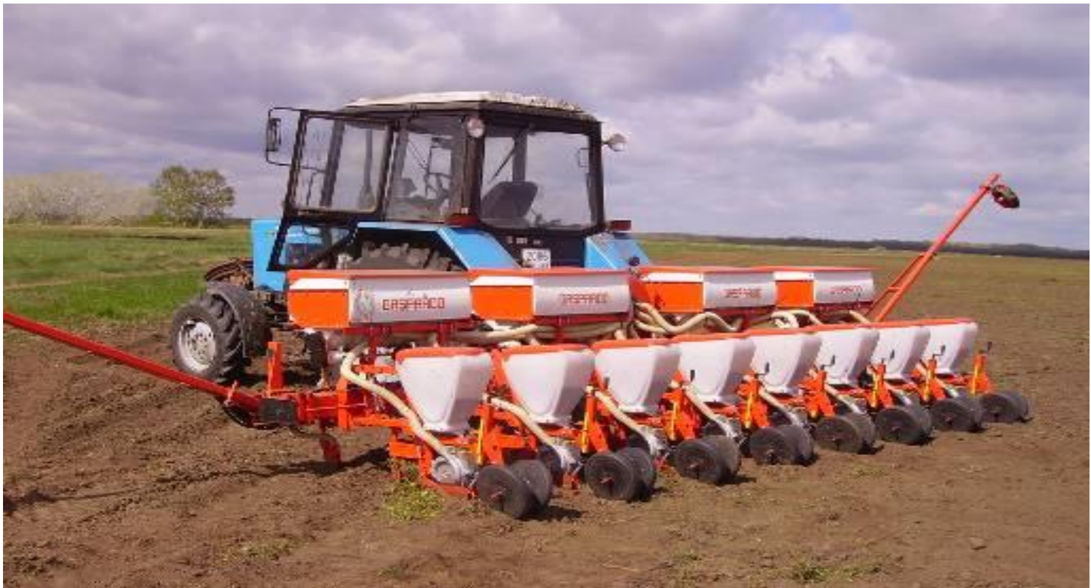
МТЗ-82 трактори билан агрегатланган УПС-8-02 8-қаторли универсал пневматик сеяланинг кўриниши
