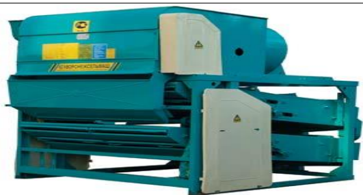
4-rasm. G'allani dastlabki tozalaydigan (3BC-20A) - AgroBaza rusumli statsionar (qo'zg'almas) mashina
