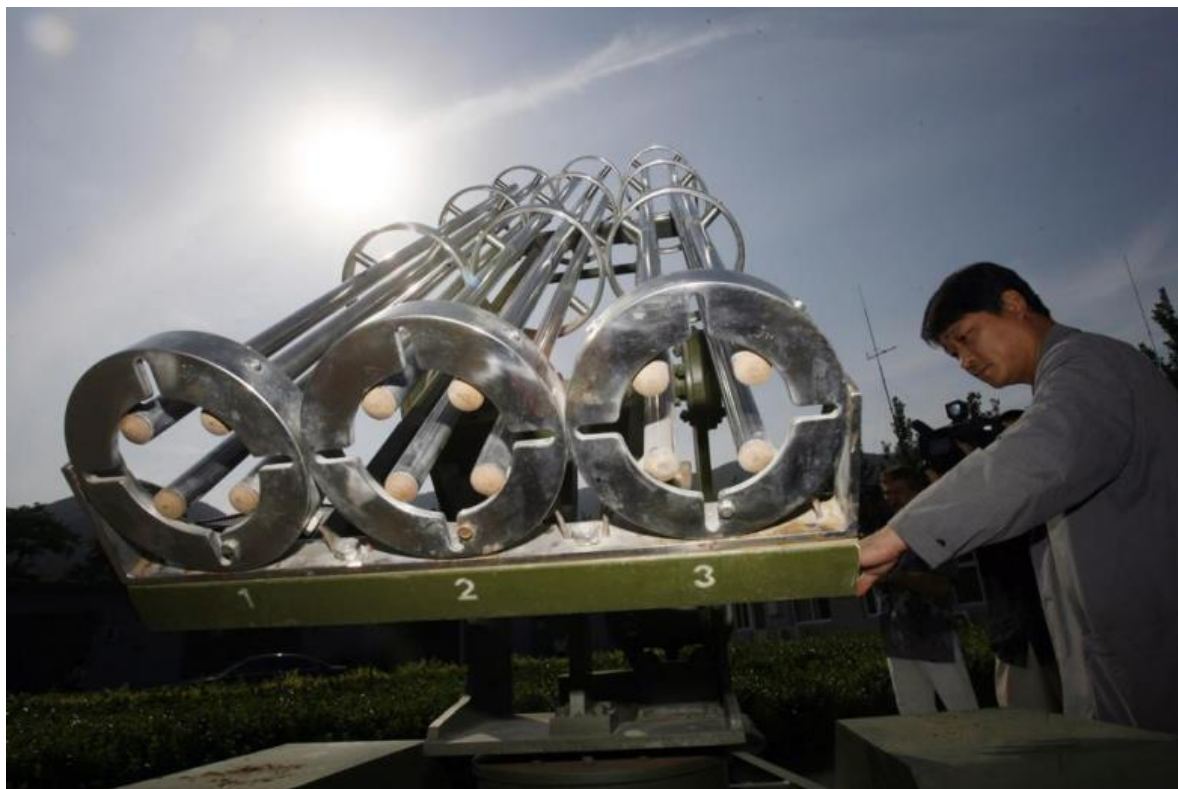
Рисунок 1. Ракетная установка, используемая для засева облаков в Метеорологическом бюро в Пекине
