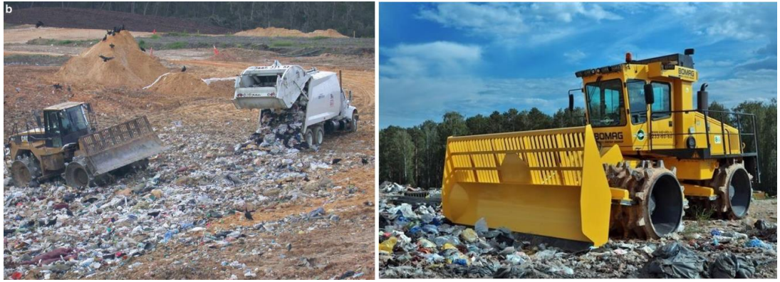
4.11 -rasm Chiqindilarni poligonda tekislash va siqish
