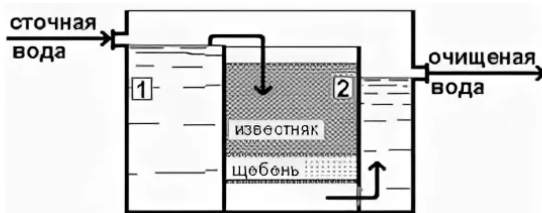
Рис. 13.1. Схема фильтра-нейтрализатора 1 – приёмная камера, 2 – фильтрующая загрузка
