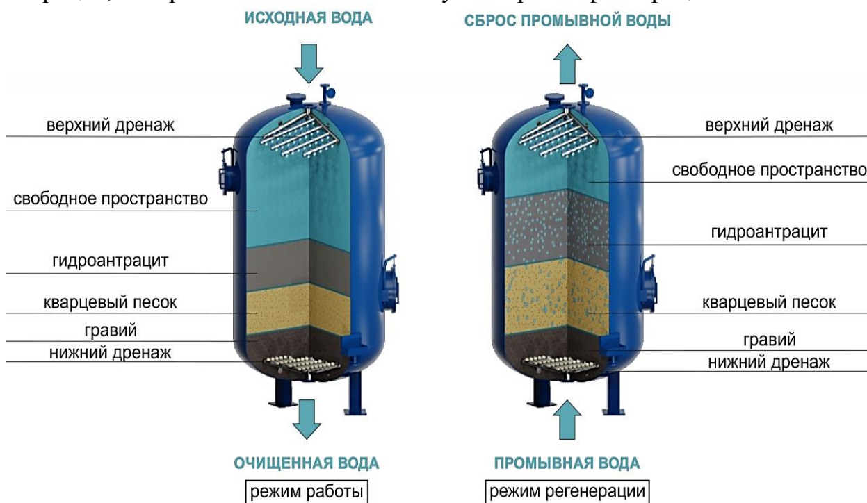
Рис. 11.14. Схема работы и регенерации напорного двухслойного фильтра
