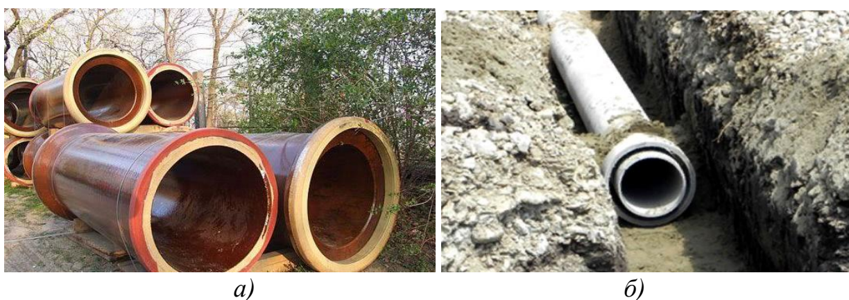
Рис. 5.3. Керамические (а) и асбестоцементные (б) канализационные трубы
