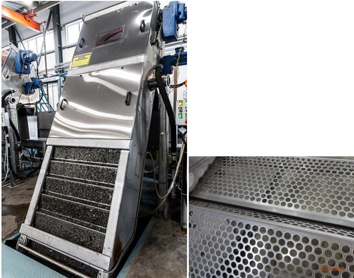
Рис. 11.4. Ленточная решетка a – общий вид, б – перфорированные пластины
