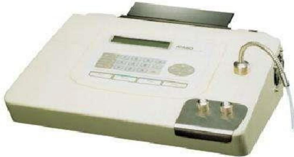
Модель DD-7 представляет собой новый измеритель концентрации, который измеряет низкие концентрации водных растворов (до 2 %) с высокой точностью ( $\pm 0.005\%$ ).
