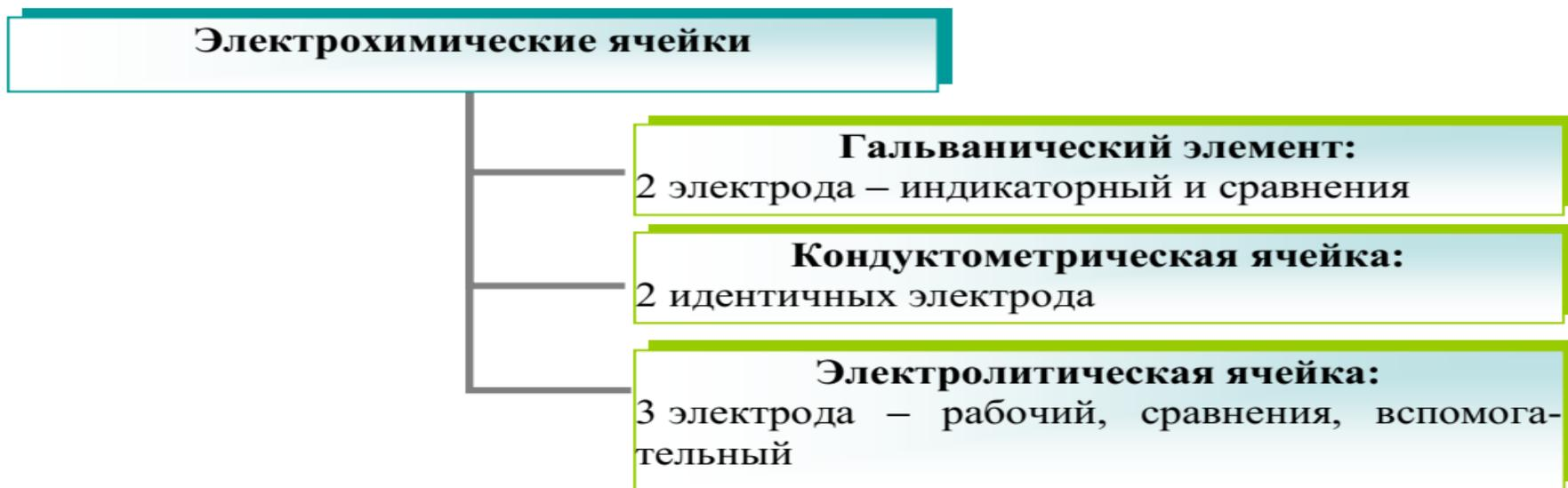
Рис. 11. Типы электрохимических ячеек
