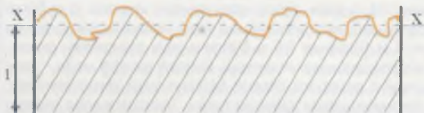
3-расм. Ҳайдалган ва юмшатиш майдон юзасининг кўндаланг кесими
