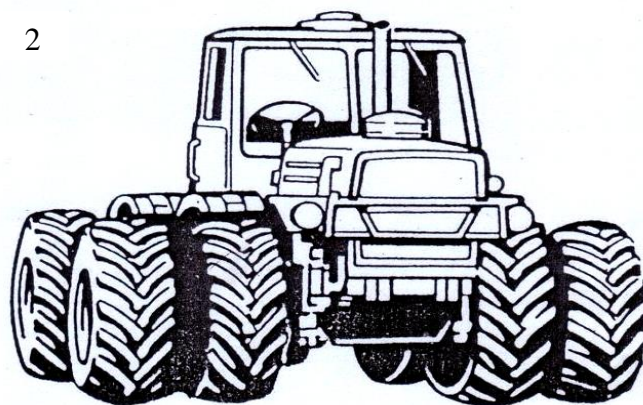
Установка сдвоенных колес на трактор Т-150К
