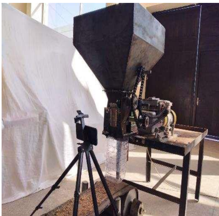
4.15- расм. Лаборатория стендида уруғ ажраткичбарабани меъёрлаш новларининг уруғлар билан тўлиб бориши жараёнини тасвирга олиш
