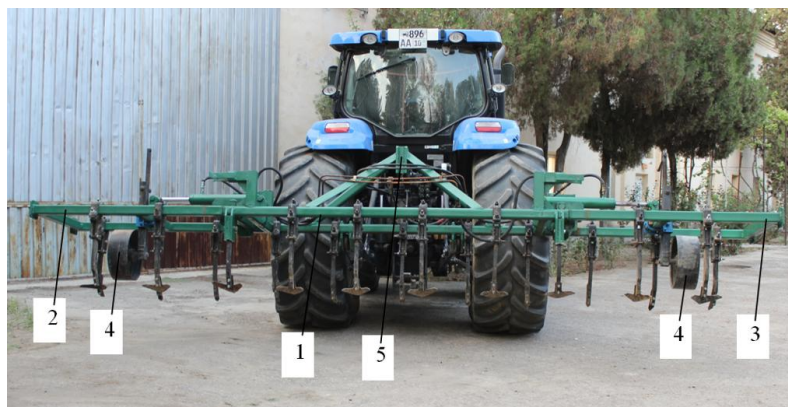
1-марказий секция; 2, 3-чап ва ўнг ён секция; 4-таянч ғилдираги; 5-осиш қурилмаси
