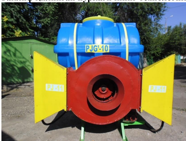
2-расм. Плантация қилиб экилган боғларга кимёвий ишлов берувчи ишчи қисм ўрнатилган универсал осма пуркагичнинг орқа томонидан кўриниши
