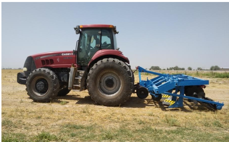
1-расм. “Magnum” МХ-255 трактори билан агрегатланган комбинациялашган машинанинг ён томонидан умумий кўриниши
