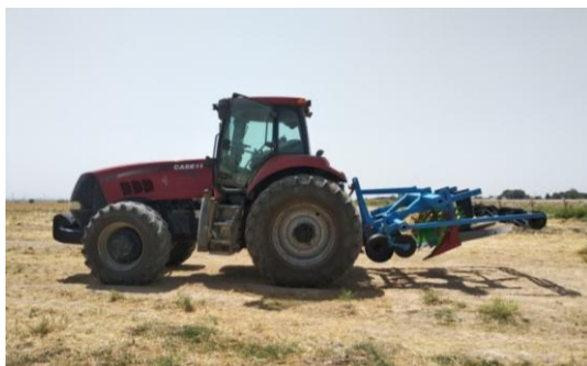
2-расм. “Magnum” МХ-255 трактори билан агрегатланган эгатсиз текис шудгорлайдиган плугнинг умумий кўриниши
