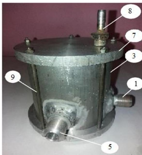
1- магнитное устройство; 2- тепловая трубка; 3-корпус; 4- фильтр;
