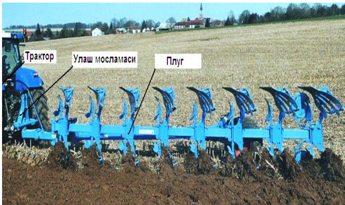
2.6-rasm. Er haydash agregatining tarkibi
