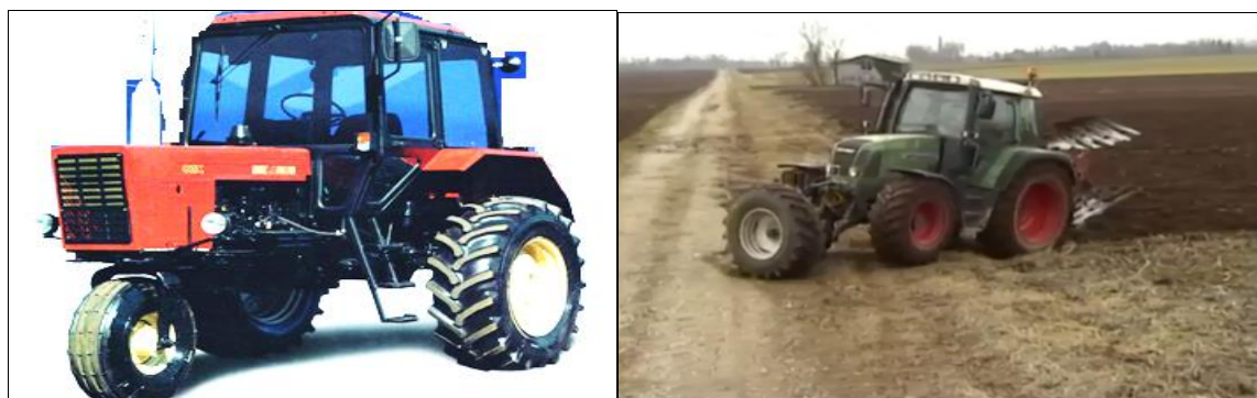
5.1-rasm. Eng kichik burilish radiusiga ega bo'lgan 2X3 sxemali (a) va maxsus g'ildirakli qurilma o'rnatilgan 4X4 sxemali (b) traktorlar
