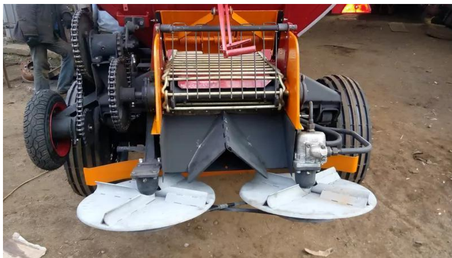
12-rasm. 1-RMG-4 rusumli bir o'qli gidravlik tizim bilan jihozlangan mineral o'g'it sepadigan mashina
