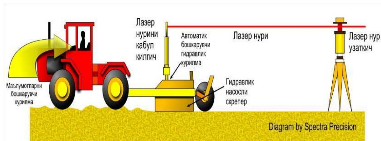
40-rasm. Lazerli tekislagichda erlarni tekislash
