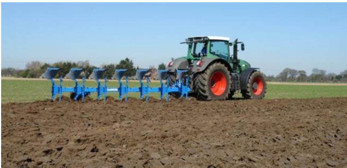
26-rasm. “Lemken Chirchiq” O‘zbekiston-Germaniya qo‘shma korxonasining EurOpal-7 4+2 osma to‘ntarma plugi
