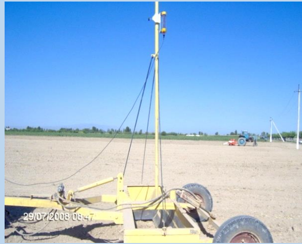
34-rasm. Lazer boshqaruvli (a) er tekislagichning (b) ko‘rinishi
