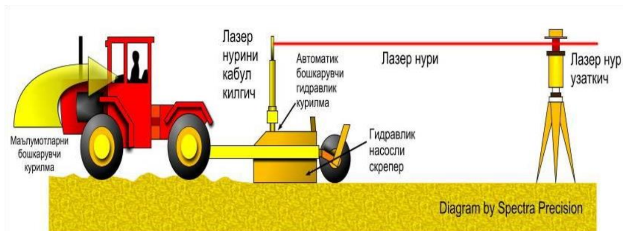
46-rasm. Lazerli tekislagichda erlarni tekislash
