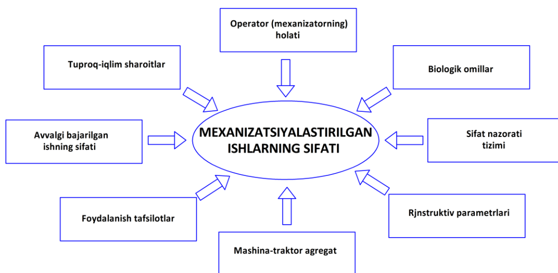
7-rasm. Mexanizatsiyalashtirilgan ishlarning unumdorligi va sifatiga erishish omillari sxemasi
