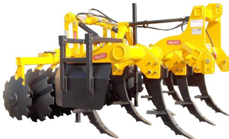
27-rasm. xorijiy kompaniyalar tomonidan ishlab chiqarayotgan zamonaviy, kombinatsiyalashgan chuqur yumshatkich namunasi
