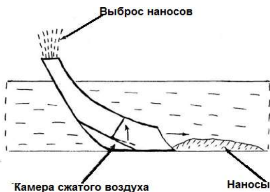
Рис. – 1.Схема работ газоимпульсного способа очистки каналов – лотков
