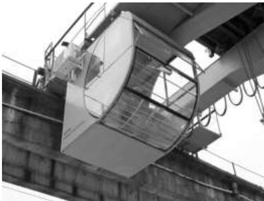
*Рисунок 4. Панорамная кабина оператора*
