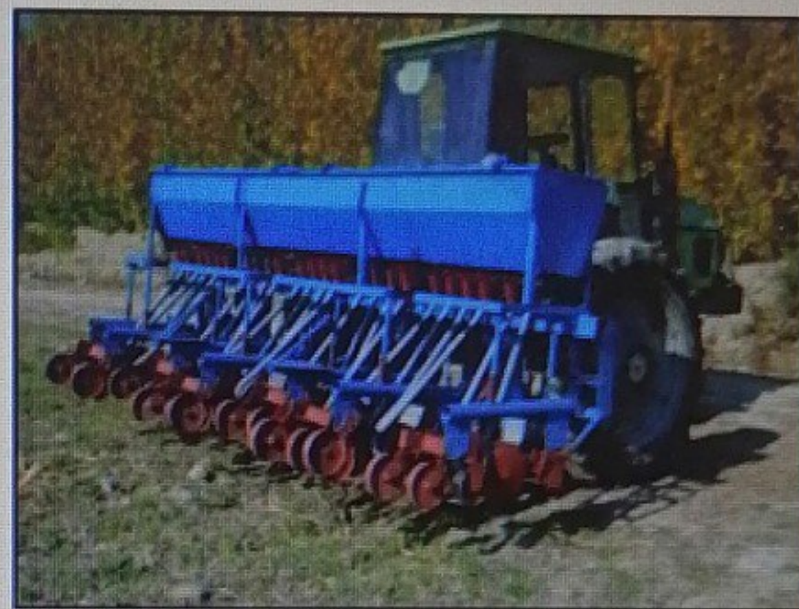
3-расм. 60 см ва 90 см схемада экувчи сеялканинг саноат вариантлари
