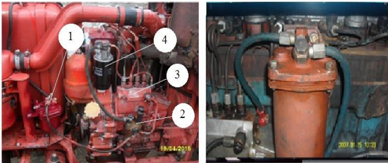
5.8 - rasm. Dizel yonilg‘isigi va bioetanolni suyuqlik yordamida qizdirib uzatish qurilmasining tizimga o‘rnatilishi
