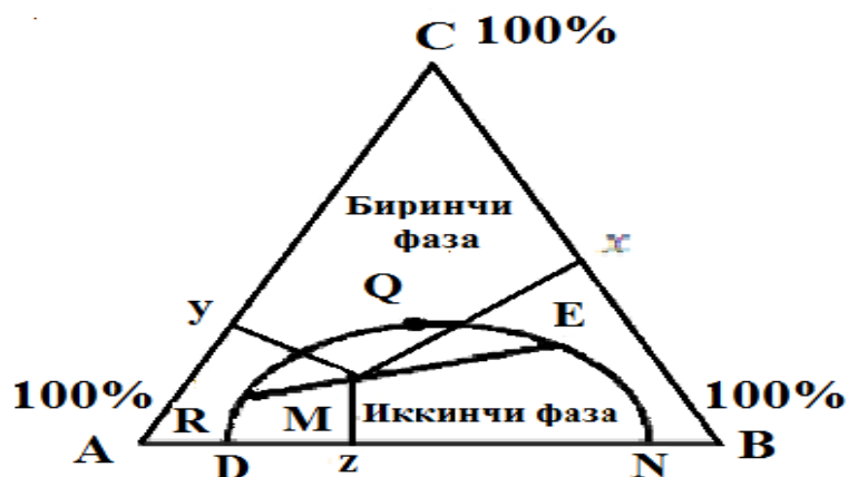
4.9 – rasm. Dizel va bioetanolning uch tarkibli tizim diagrammasi
