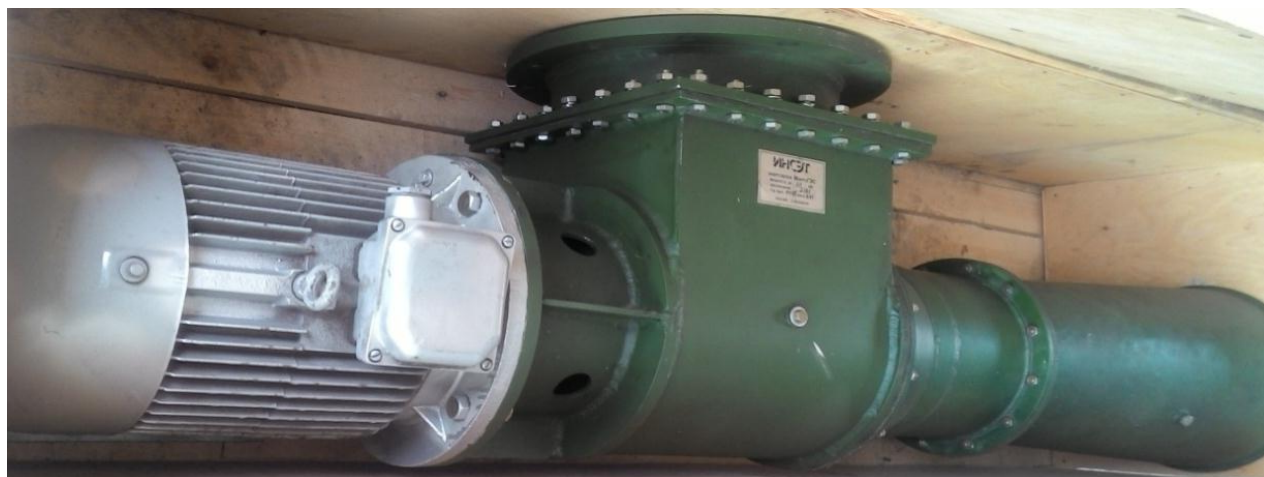
4-расм. Қуввати 10 кВт бўлган МикроГЭС 10Пр нинг кўриниши.
