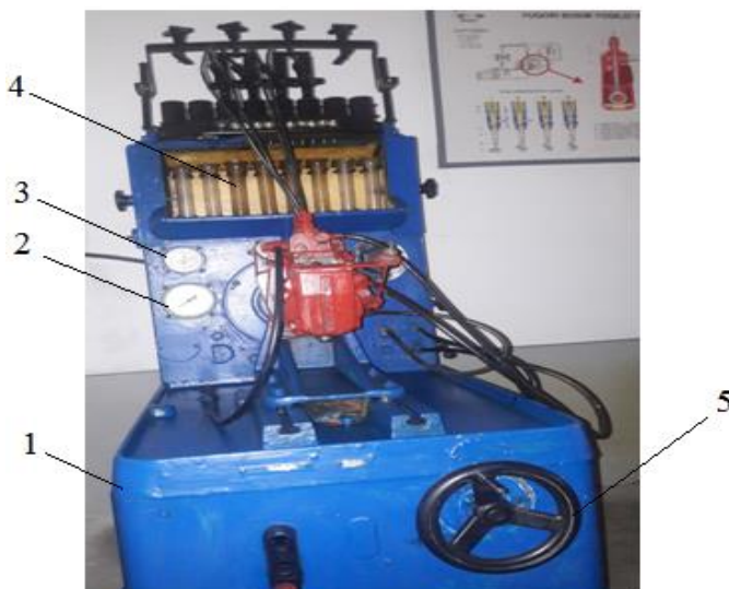
1-асос; 2-манометр; 3-тахометр; 4-ўлчаш мензуркалари; 5- юритма валининг айланиш тезлигини ростловчи мурват
