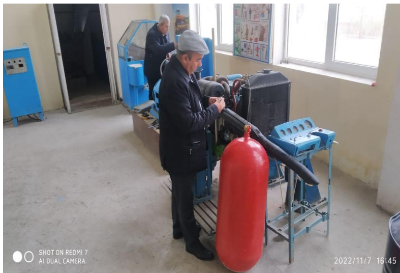
36-расм. “Cummins ISB6.7250” дизел двигателини синов стендига мослаштириш жараёни
