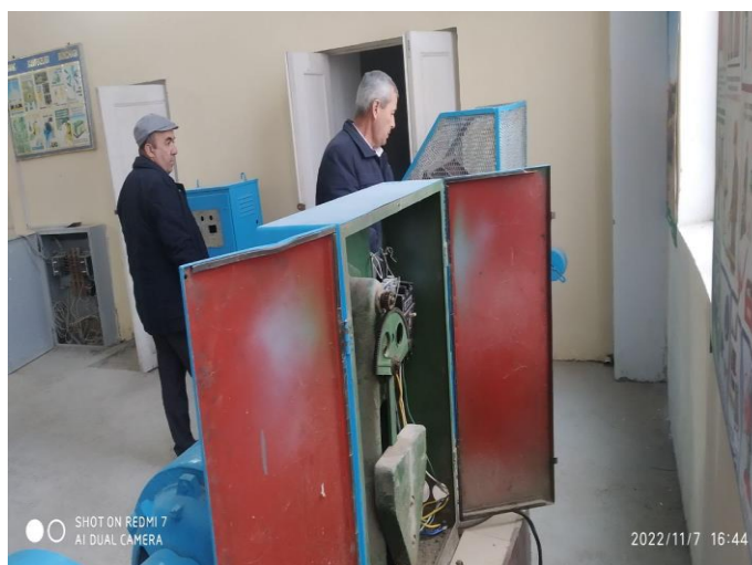
41-расм. Генератор тартиботида ишлаганда юкланишни ростлаш қурилмаси.
