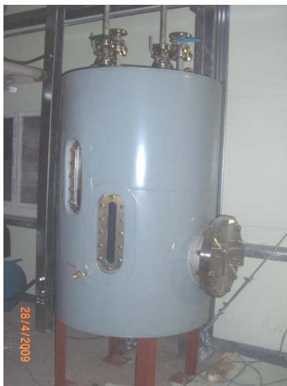
34- расм. Биогазни “сувли” тозалаш усули
