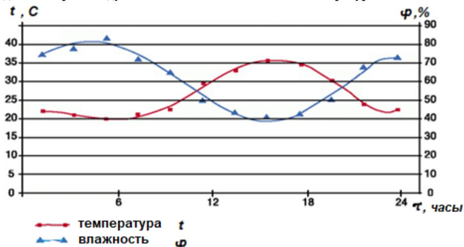
Рис. 3. Цикл температуры и влажности воздуха в течение летних суток внутри опытной теплицы при работе установки испарительного охлаждения
