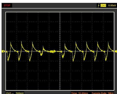
2-расм. Изолятор юзаси бўйича оқиб ўтиш токлари пайдо бўлган хол.
