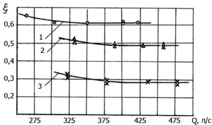
Рис. 2. График зависимости коэффициента сопротивлений всасывающего трубопровода от подачи насоса марки Д2000-34 (18НДс n = 750 об/мин): 1 – для камеры с осаждением наносов; 2 – для типовой камеры со смывом отложения наносов; 3 – для камеры с струенаправляющей стенкой и нанососмывающим устройством
