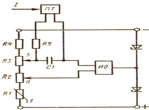
2.8 – чизма. Трансформаторнинг ресурсини назорат қилувчи асбоннинг структуравий схемаси.  $R_1$  - ҳарорат резистори;  $R_2 \dots R_5$  - резисторлар; ПТ - ток ёки кучланиш ўзгарткичи; ЎМ - ўлчов механизми;  $C_1$  - конденсатор;
