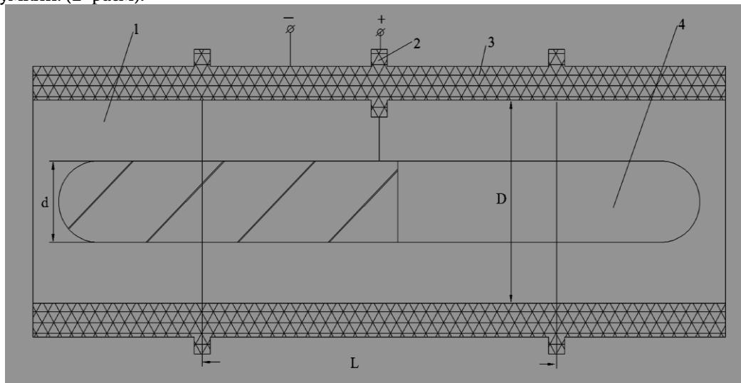
2-расм. Туз эритмаларига доимий ток билан ишлов бериш мосламасини асосий параметрлари: 1-сув тармоги трубалари; 2-ўтиш изолятори; 3-алюминиили ташқи электрод; 4-алюминиили ички электрод; d-ички электрод диаметри; D-ташқи электрод диаметри; L-ишлов бериш зонасини узунлиги
