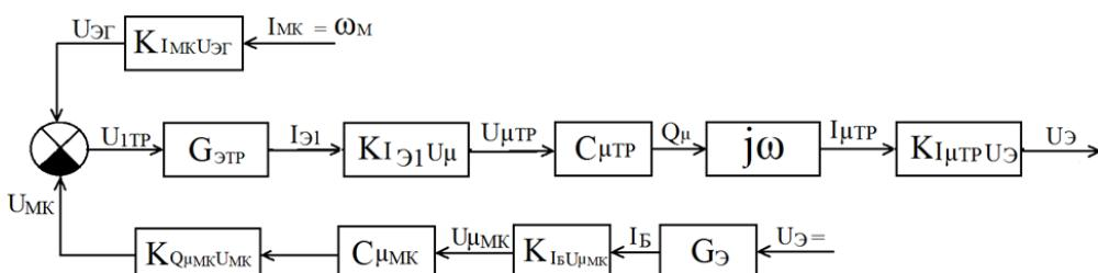
2 - расм. Марказлаштирилган электр схемаси асосида ишлайдиган магнит кучайтиргич қурилмасини бошқаришнинг параметрик структура схемаси
