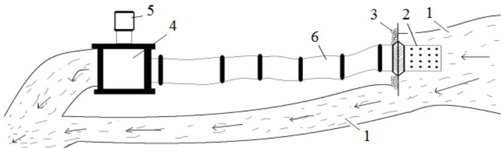
2-расм. Кўчма гидроэлектрстанциянинг ўрнатиш схемаси
