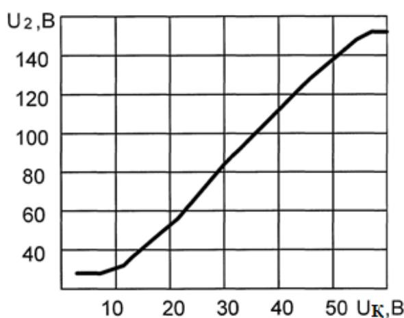
**1.4 расм. Частотаси 1000 Гц бўлганда генераторни салт юриш күчланишини қўзгатув күчланишига боғлиқлиги графиги**
