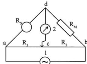
1- расм. Кондуктометрнинг электрон чизмаси.
