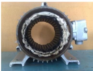
1.1 расм. Даврий импульс кучланишли машина генераторини статори
