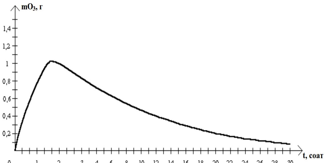
Расм 4. Озон массасининг  $U_{\text{эфф}} = 10 \text{ кВ}$  кучланишдаги синтез вақтига ва  $V_g = 0,6 \text{ л}/\text{мин}$  газ оқимига боғлиқлиги.
