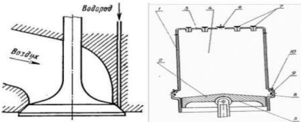
3-расм. В.С. Кащеевтомонидан ишлаб чиқилган водородлидвигатель схемаси: 1-цилиндр қапқоғи, 2-поршень, 3-копқоқ усти, 4-камера, 5-поршень ичи, 6-ҳаво киритиш клапани, 7-чиқариш клапани, 8-предкамера, 9-ҳаво бериш клапани, 10-ёндириш свечаси.
