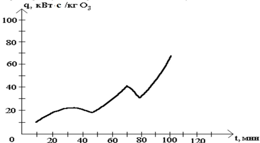
Расм 6. Озон энергиясини истеъмол қилишнинг кучланишдаги синтез вақтига боғлиқлиги.  $U_{\text{эфф}}=10 \text{ kV}$  ва gaz oqimining tezligi  $V_r = 0,6 \text{ л/мин.}$
