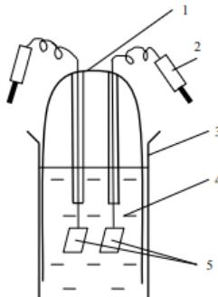
26-расм. Кондуктометрик ячейканинг чизмаси: 1 – ячейка нусхаси; 2 – ячейкани улаш учун вилка; 3 – стакан; 4 – электролит эритмаси; 5 – платина пластиинка электродлари.
