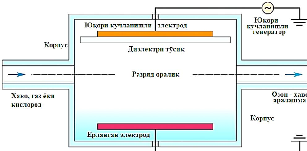
Расм 3. Тўсиқли туридаги озон генераторининг принципиал схемаси
