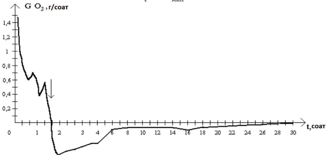
Расм 5. Озон ишлаб чиқариш  $G$  нинг волтажидаги синтез вақтига боғлиқлиги.  $U_{\text{эфф}} = 10 \text{ кВ}$  ва газнинг сарфланиши  $V_g = 0,6 \text{ л}/\text{мин}$ .
