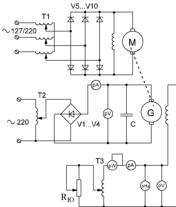
**1.3 расм. Даврий импульс күчланиши машина генераторини характеристикаларини тадқиқ этиш учун стендни принципиал схемаси**
