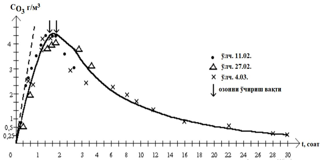
Расм 3. Озон концентрациясининг кучланишдаги синтез вақтига боғлиқлиги  $U_{\text{эфф.}} = 10 \text{ kV}$  ва газ оқимининг тезлиги  $V_t = 0,6 \text{ л/мин.}$
