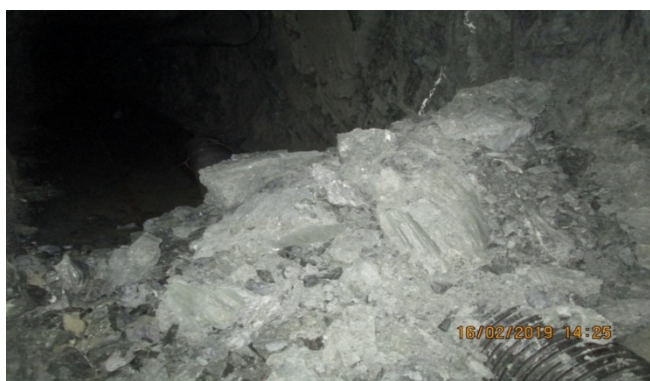
1-расм. Ходжадик кони 3-штольня 5-штрек 170-190 метрида тоғ жинсларининг ўпирилиб ажралиб тушиш ҳолати.
