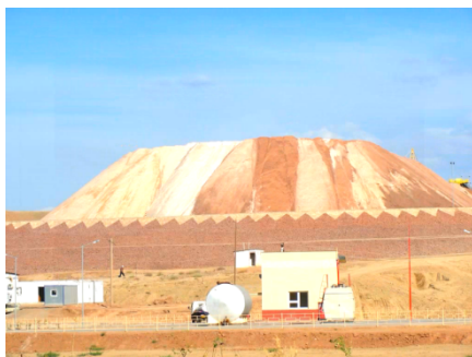
4-расм. Тепакўтон тоғ-кон мажмуаси ҳудудидagi қазилган техник туз ва сильвинитни қайта ишлаш натижасида ҳосил бўлган чиқиндиларининг ағдармаси
