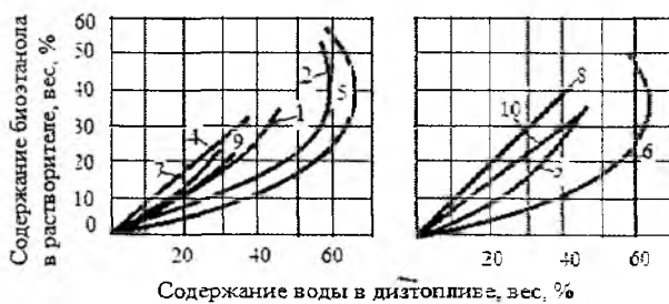
Рис. 7. Кривые распределения дизтоплива между водой и различными растворителями: 1 – биоэтанол; 2 – дизтопливо; 3 – гексалинацетат; 4 – метилциклогексанон; 5 – n -дибутыловый эфир; 6 – октилацетат; 7 – метилизобутилкетон; 8 – изофорон; 9 – изоамилацетат; 10 – диизопрпилкарбинол
