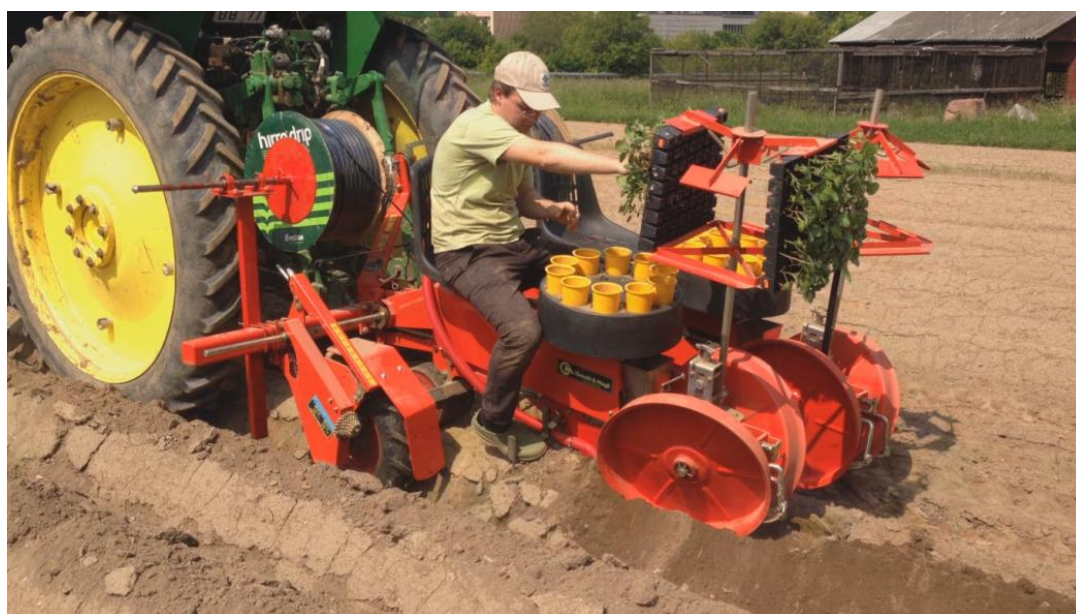
Рис-4. Укладчик капельной ленты на базе рассадопосадочной машины Cheschi & Magli
