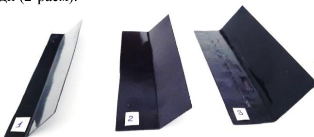
1, 2, 3 – мос ҳолда эни 700 мм, узунлиги 50, 100 ва 150 мм ўлчамларда тайёрланган шиббаловчи иш органлар
