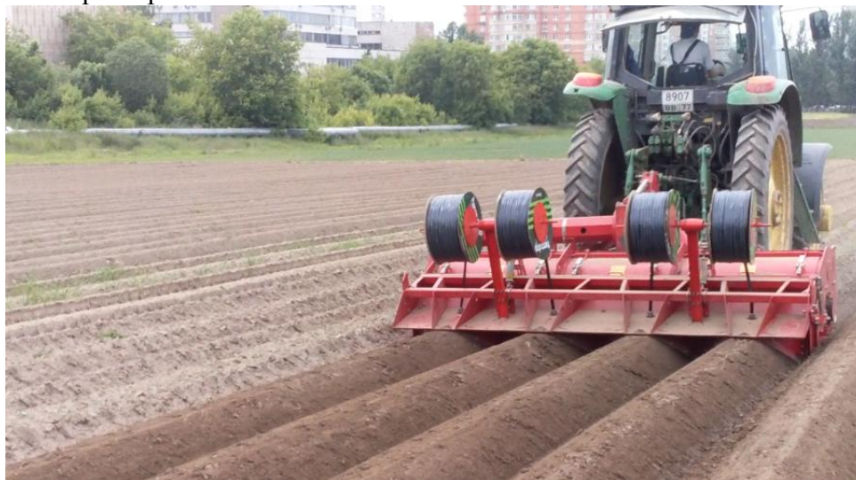
Рис-3. Укладчик капельной ленты на базе гребнеобразователя Grimme GF-75/4
