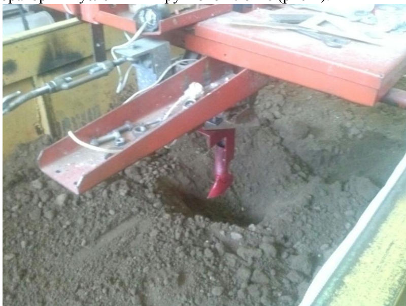
Рис-1. Испытание модели рабочего органа в грунтовом лотке
