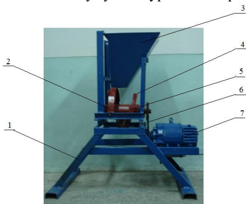
2-расм. Винтсимон озуқа майдалаш аппаратини экспериментал тадқиқ қилиш стенди
