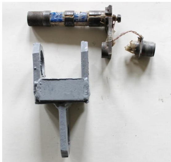
Рис-1. Калибровочное приспособление и двухопорный тензометрический палец
