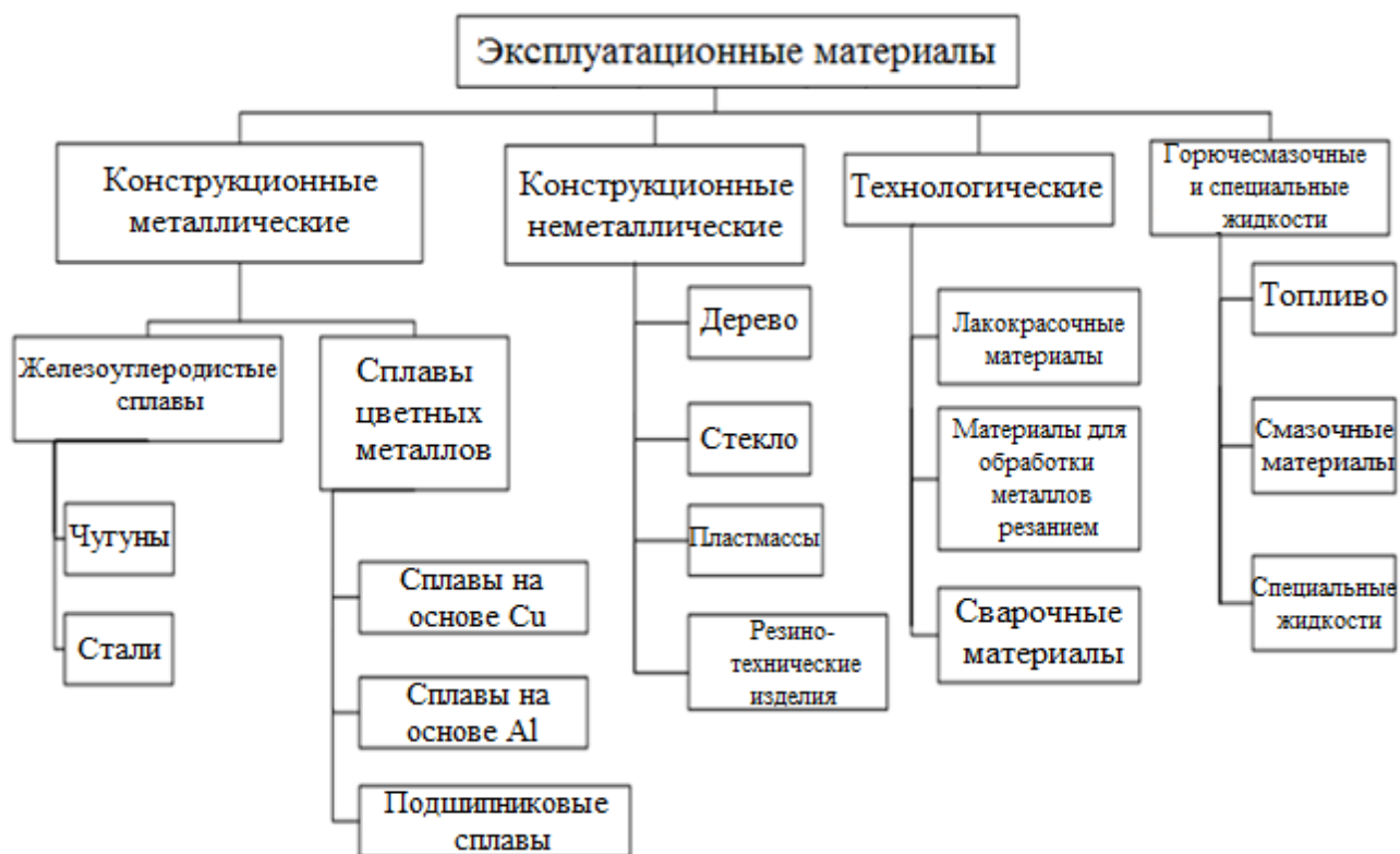
Рис. 2. Классификационная схема эксплуатационных материалов
