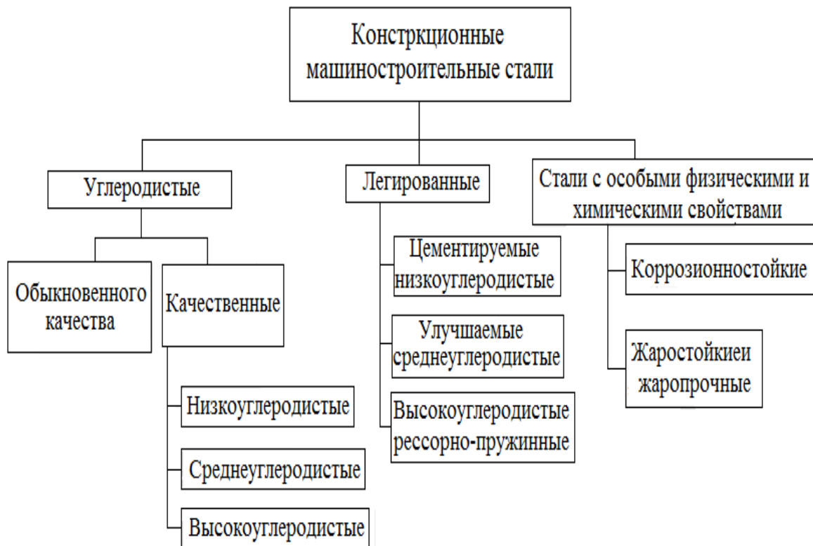
Рис. 10. Классификация конструкционных машиностроительных сталей
