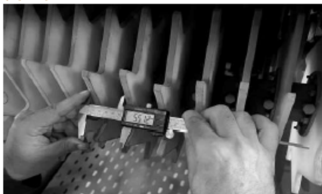
1-расм. Барабаннинг дисклари орасидаги масофани аниқлаш.
