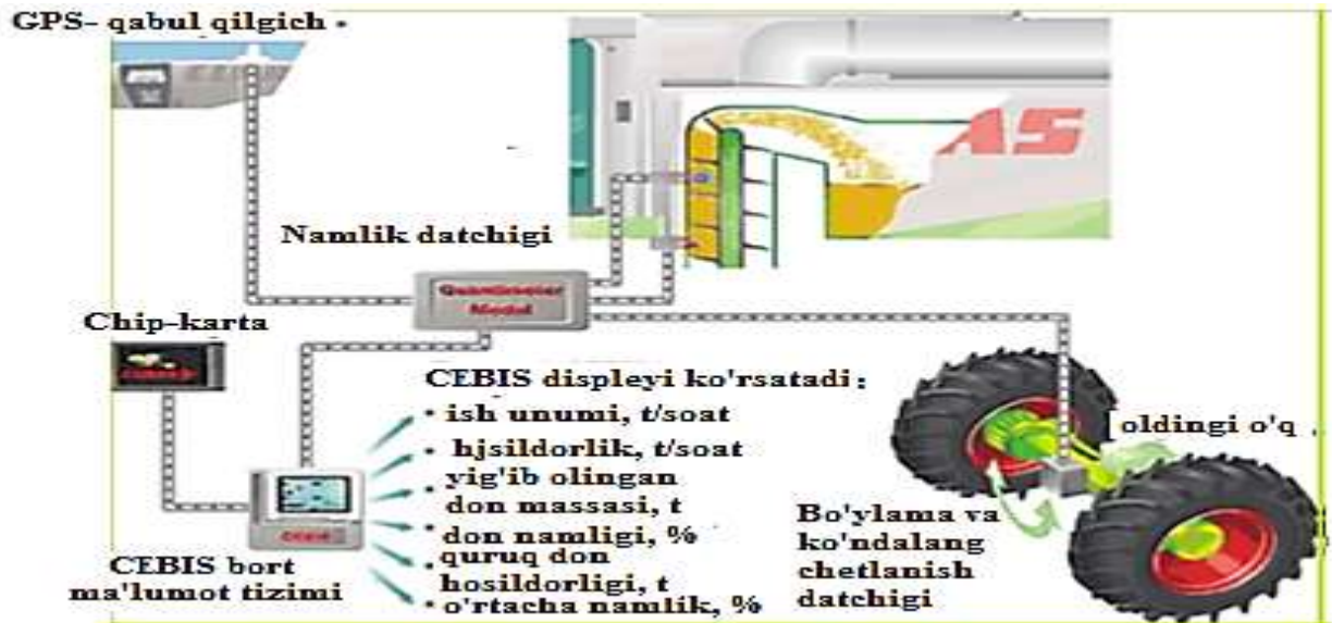
10.4-rasm.. Hosildorlikni monitoringlash tizimi elementlari sxemasi
