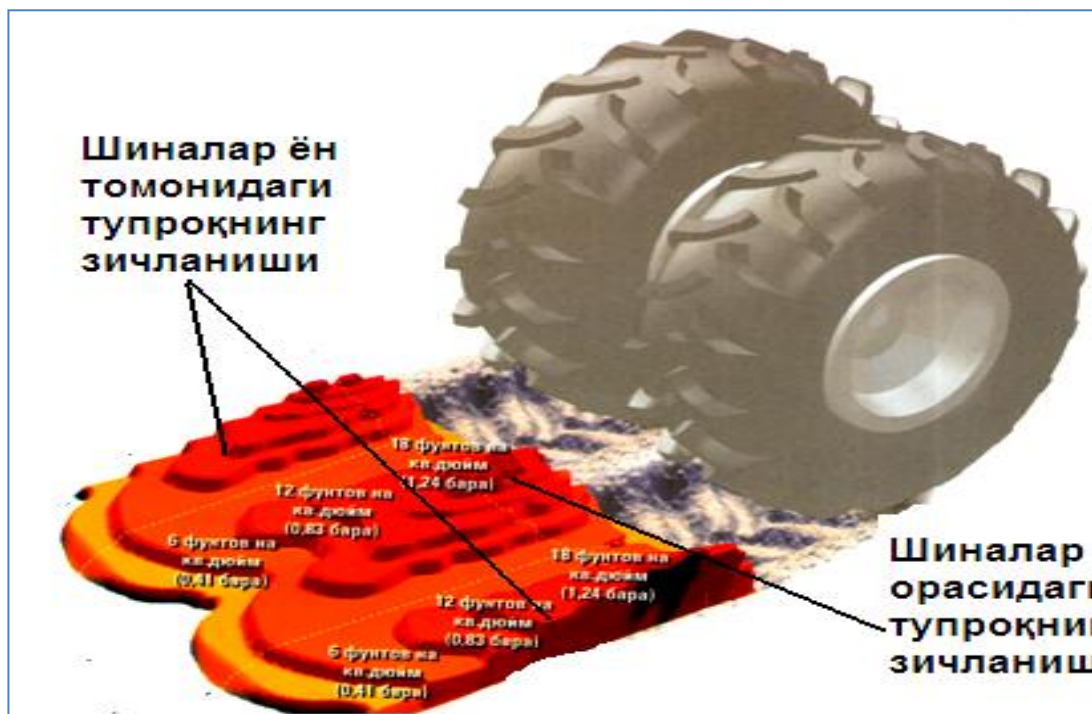
4.7-rasm. Qo'sh g'ildiraklar orasidagi tuproqning zichlanishi.
