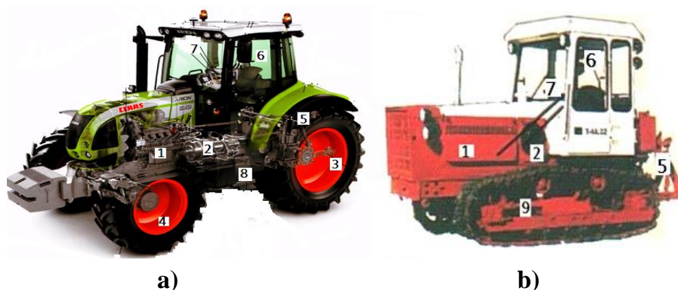
1.6-rasm. Traktorlarning tuzilishi: a-g'ildirakli; b-zanjirli; 1- dvigatel; 2-transmissiya; 3-orqa g'ildirak; 4- oldingi g'ildirak; 5-o'rnatish qurilmasi; 6-kabina; 7- boshqarish mexanizmlari; 8-quvvat olish vali; 9- zanjirli yurish qismi.
