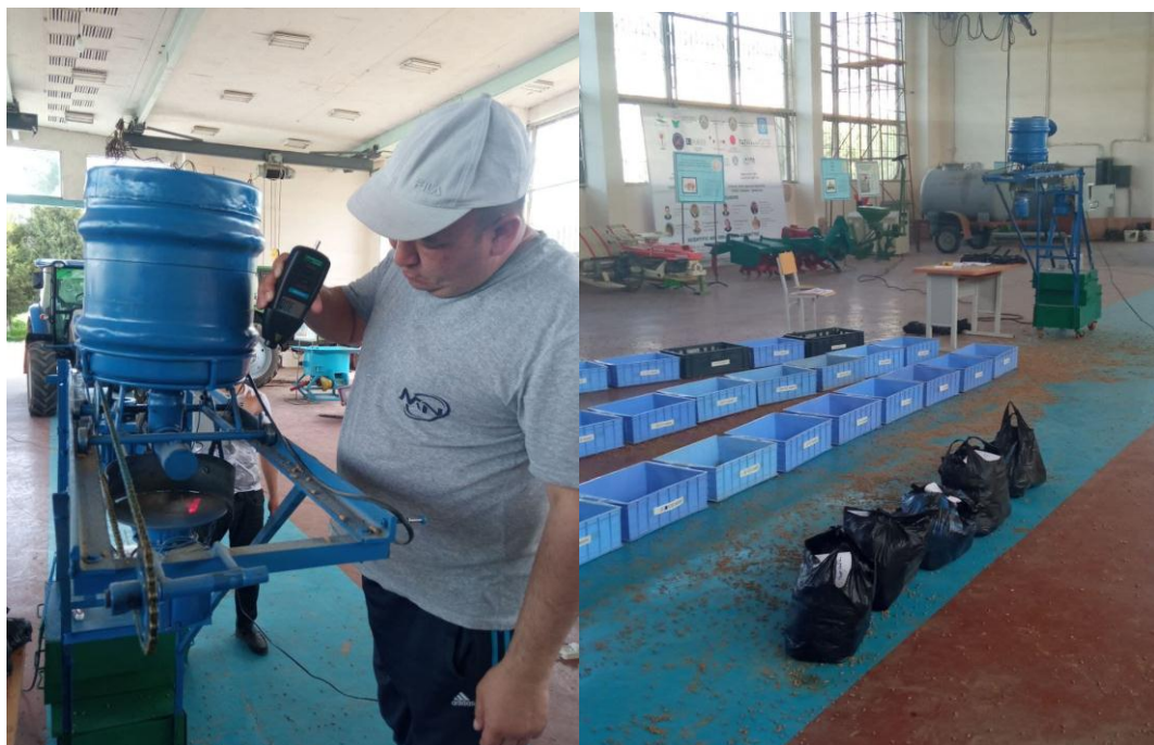
1-rasm Baliqlarga diskli ozuqa tarqatkich qurilmasi
