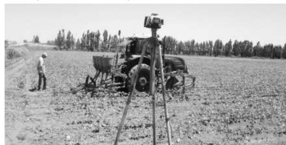
6-расм. «Ишчанов Одилбек» фермер хўжалигининг 1-тажриба участкасида автоматлаштириш йўли билан эгатларни зичлаш қурилмасининг ишлаши.
