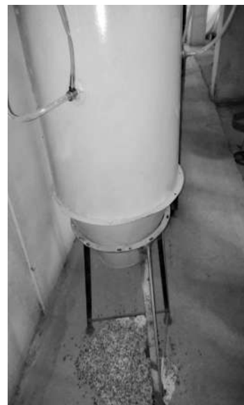
Рисунок 1. Процесс протравливания опущенных семян на разработанной цилиндрической мешалке.
