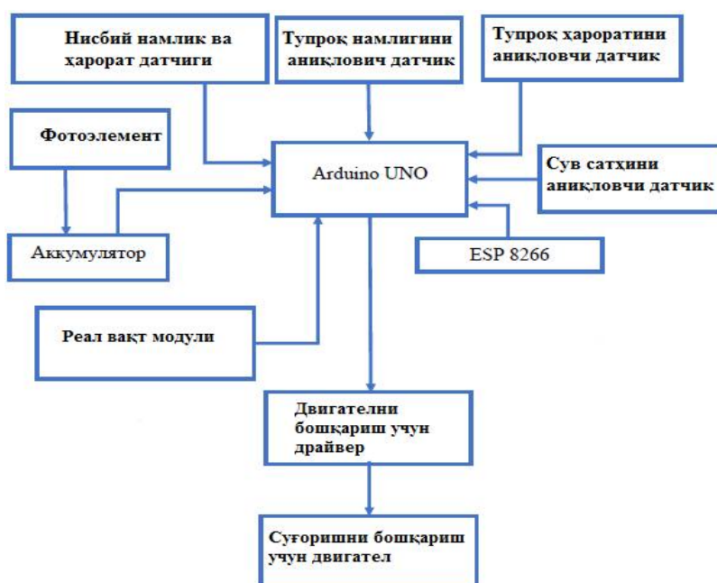
1-расм. Ўсимликларни томчилатиб туғоришда интеллектуал датчикли тизимнинг блок схемаси
