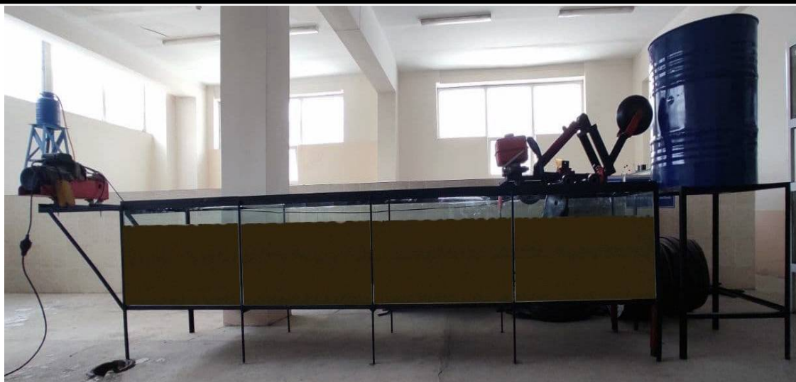
3- расм. Суғориш эгатлари гидравликасининг тадқиқоти учун ойналанган лаборатория стенд-лотогининг асл нусхаси.
