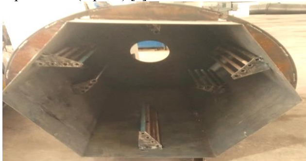
3-расм. Дориланган чигитни олти қиррали аралаштириш барабанининг ички ишчи юзасига қувурли планкаларни ўрнатиш жараёни кўриниши
