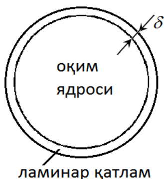
4.9-rasm. Turbulent oqim ko‘ndalang kesimi L.Prandtl taklifi.
