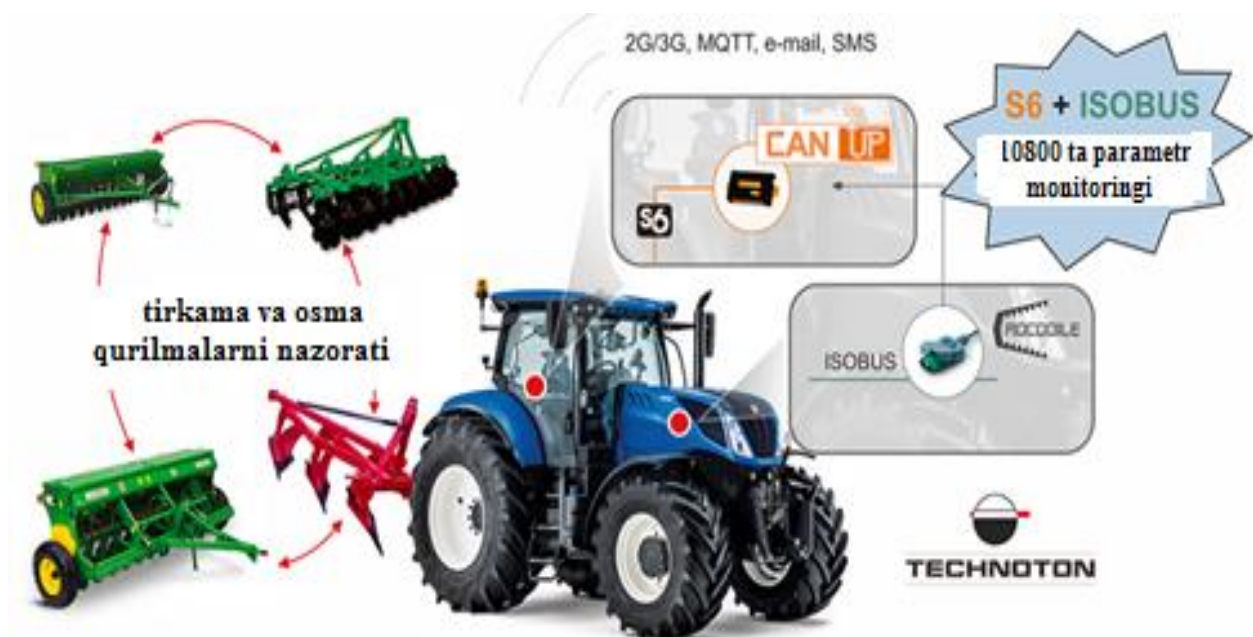
7.76-rasm. Traktor va QXM dagi ISOBUSning asosiy elementlari
