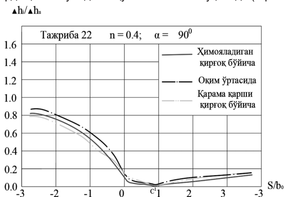
4-расм. Сув юзасининг ўлчамсиз бўйлама қирқими (сув олувчи иншоот затворларининг барчаси 50 % га очик)
