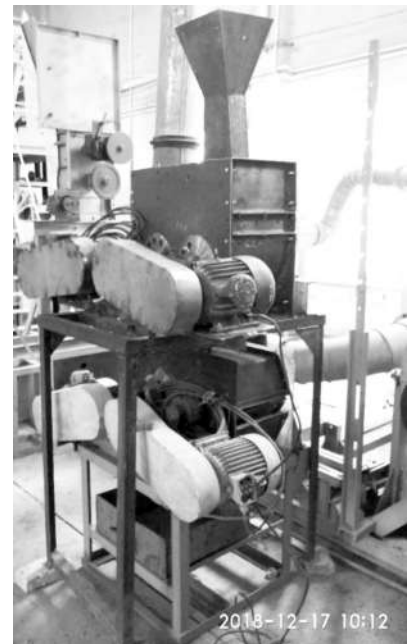
1-расм. УЧДМ машинаси лаборатория стендининг юқори камерасига арра-чўткали цилиндрларни йиғилган ҳолати кўриниши
