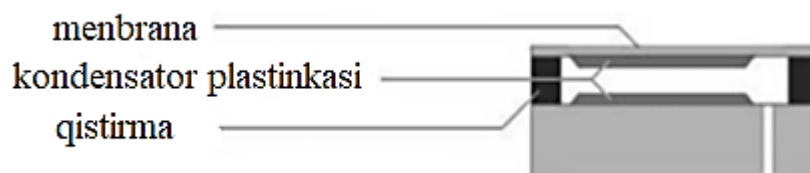
2.4-rasm. Sig‘imli keramik bosim o‘tkazgich
