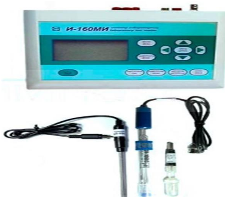
21-rasm. Motor moylari tarkibidagi ishqor sonini aniqlash uchun qurilma. 1-rN metr; 2.3.4 - elektrodlar;
