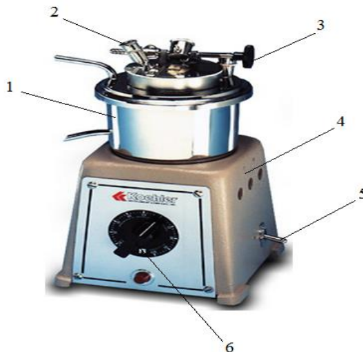
13-rasm. Tagu K14670 dizel onilg'isining chaqnash haroratini aniqlash qurilmasi. 1-yopiq tigel; 2-uchqun hosil qilgich; 3-yonuvchi pligni rostlagich; 4-issilikka chidamli asos; 5-qizdirgichni ishga tushurgich; 6-haroratni o'rnatish dastagi.
