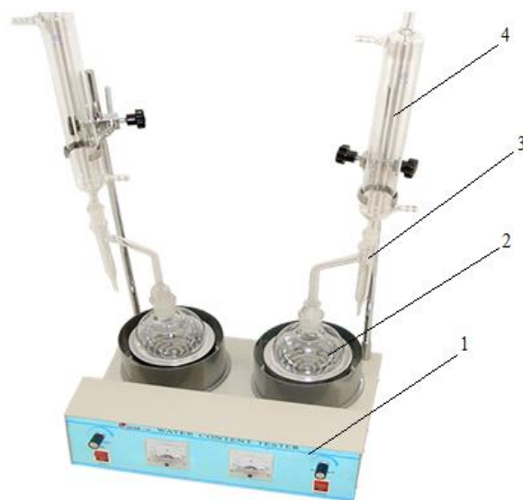
22-rasm. Moy tarkibidagi suvni miqdorini aniqlash 1 – kolbani qizdirgich; 2-kolba; 3 – qabul qilgich-tutgich; 4-sovutgich.
