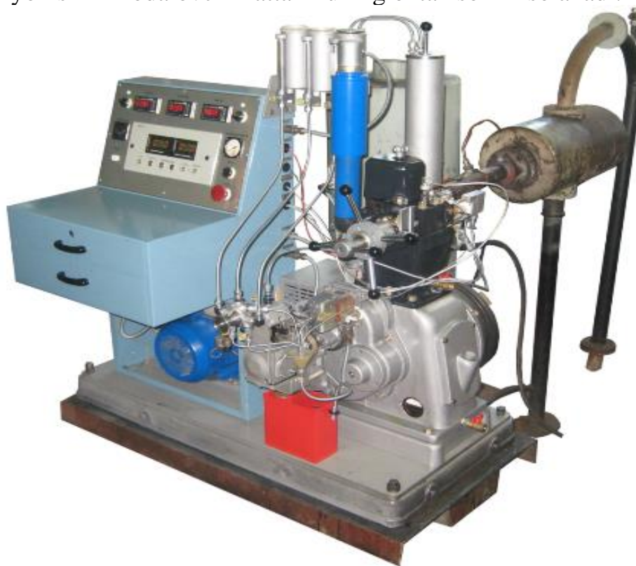
7-rasm. Motor va tadqiqot usuli bo'yicha avtomobil benzining oktan sonini aniqlash uchun UIT-85 qurilmasi
