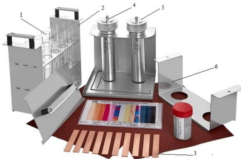
9-rasm. Mis plastinasiga neft mahsulotlarining korroziyon ta‘sirini aniqlash apparati. 1-probirka; 2- taglik; 3- mis plastina; 4,5 - sinalayotgan mahsulot; 6-sinalayotgan eritma uchun qopqoq.
