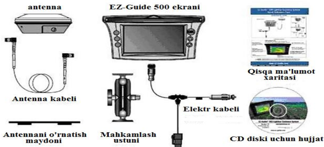
2-расм. Параллел ҳаракатланиш тизимининг стандарт ташкил этувчилари
