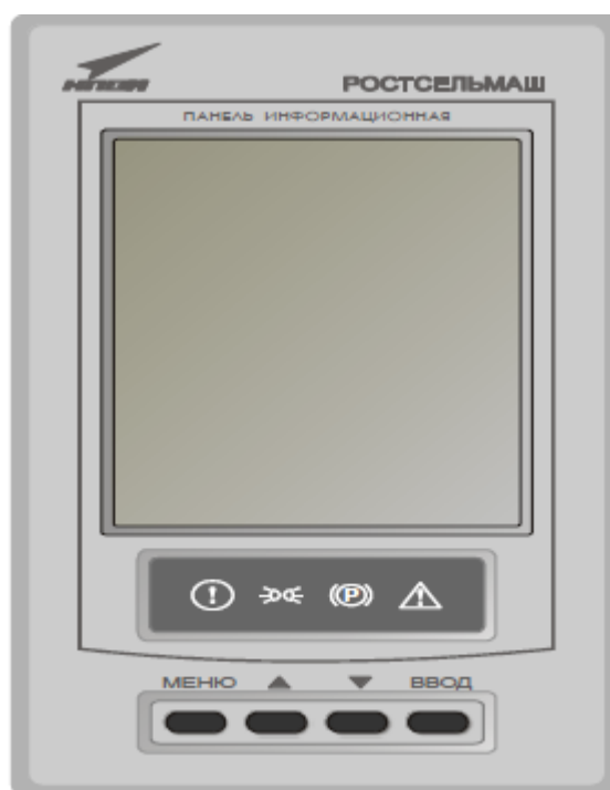
2-расм. Ҳосилдорликни даврий равишда аниқлаб бориш учун комбайн кабинасига ўрнатилган дисплей
