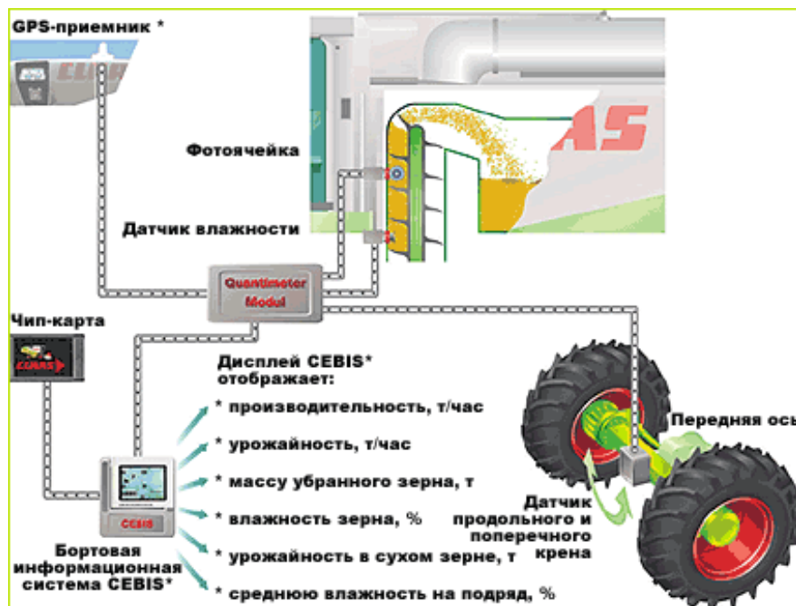
6-расм. Ҳосилдорликни мониторинглаш тизими элементлари схемаси
