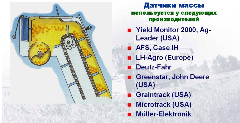
7-расм. Ғалла комбайни бункеридаги элеваторга дон оқими зарба кучини сезувчи датчикни жойлашиш схемаси
