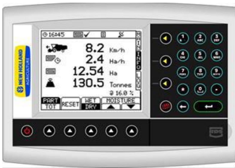
17-расм. New Holland комбайнларининг ҳосилдорликни лаҳзаларда аниқлаш тизимининг монитори
