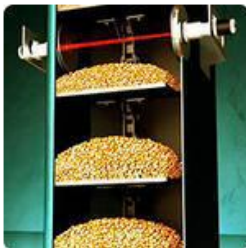
10-расм. Дон миқдорини ҳажм бўйича аниқлаш датчиги
