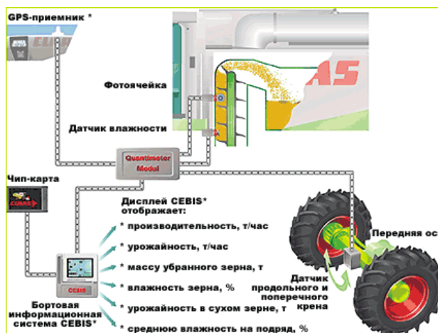
6-расм. Ҳосилдорликни мониторинглаш тизими элементлари схемаси
