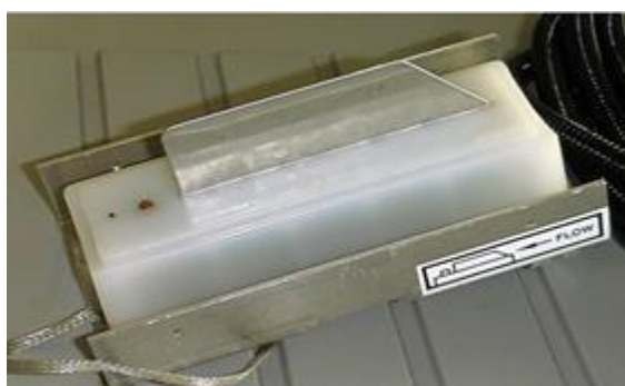
12-расм. Дон намлигини аниқлайдиган ҳажмий турдаги датчик
