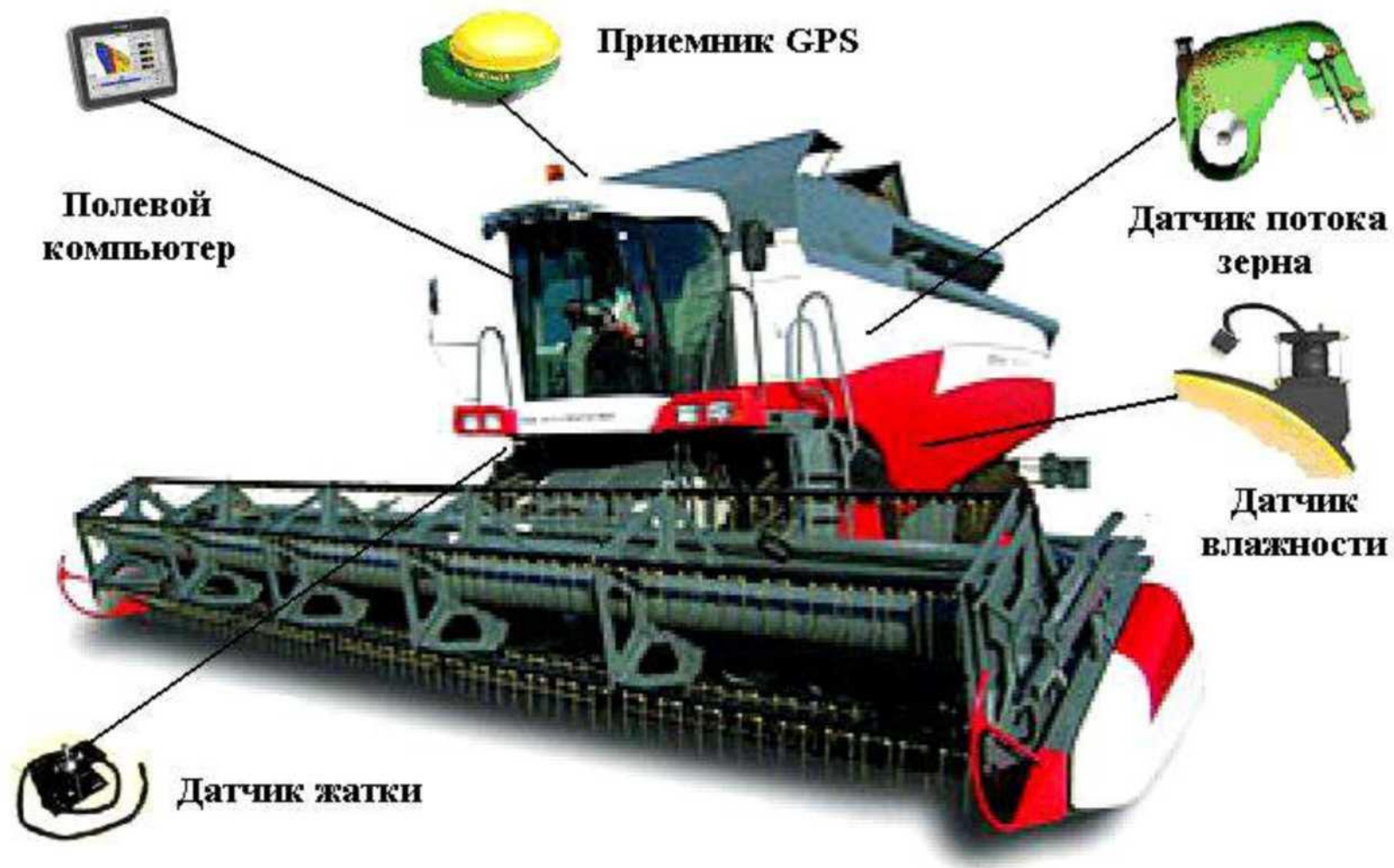
2-расм. Ҳосилдорликни мониторинглаш тизими жиҳозларининг ғалла комбайнида жойлашиши
