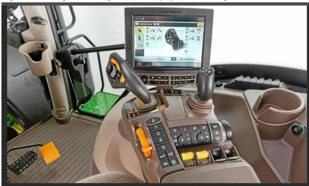
7-расм. Кабинада жойлашган тизим назорати панели
