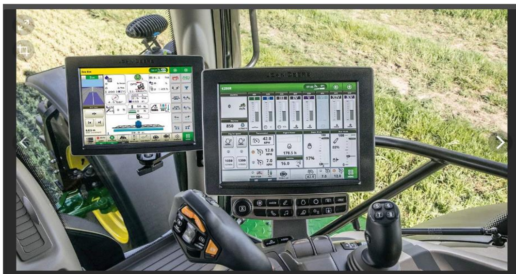
6-расм. Кабинада жойлашган борт компютерлар
