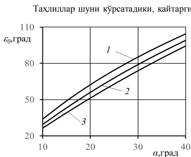
4-расм. Тикланиш коэффициентининг турли қийматларида \epsilon_0 бурчакни \alpha бурчакка боғлиқ равишда ўзгариш графиги
