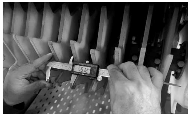
1-расм. Барабанинг дисклари орасидаги масофани аниқлаш.
