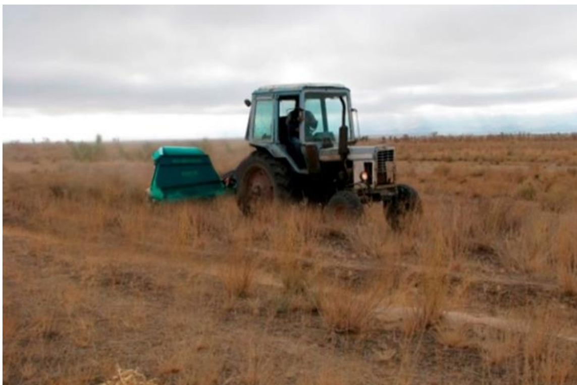
4.2-расм. Чўл озуқабоп ўсимликлари уруғли аралашмасини йиғиштирадиган машинанинг иш жараёнидаги кўриниши
