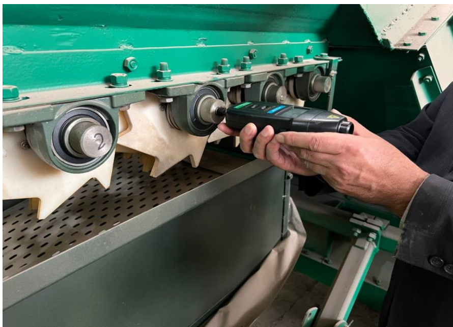
3.2-расм. Барабанлар чизиқли тезлигини аниқлаш
