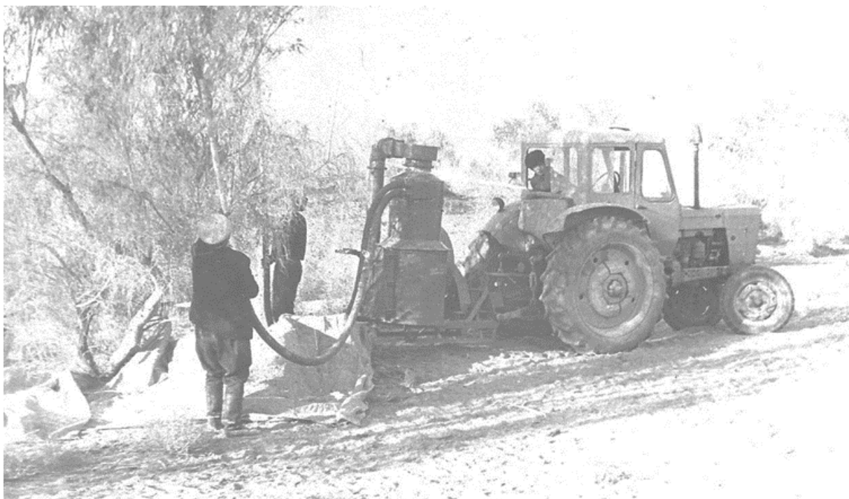
1.17-расм. ССМ-1 уруғ йиғиштириш машинасида саксовул уруғини йиғиштириш жараёни
