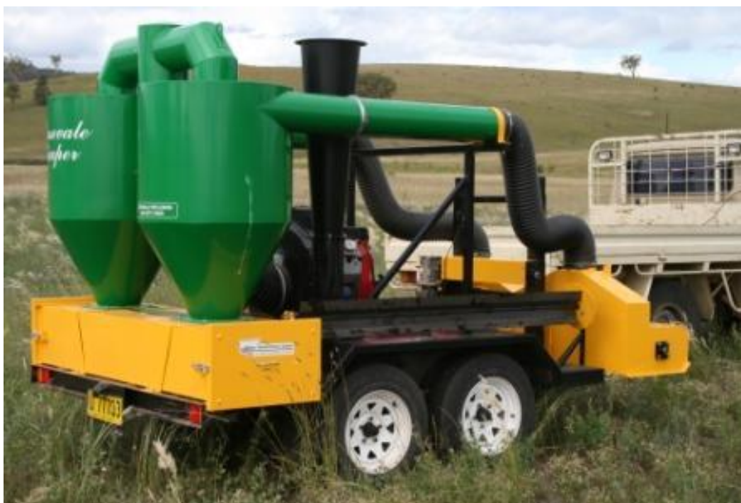
1.26-расм. Австралияда ишлаб чиқилган ўт уруғларини йиғиштирадиган комбайн
