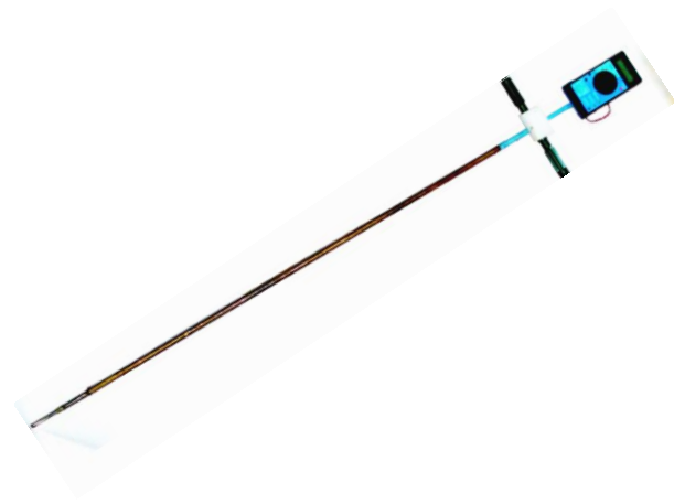
Рисунок 1. - Общий вид штыревого кондуктометра отечественного производства.
