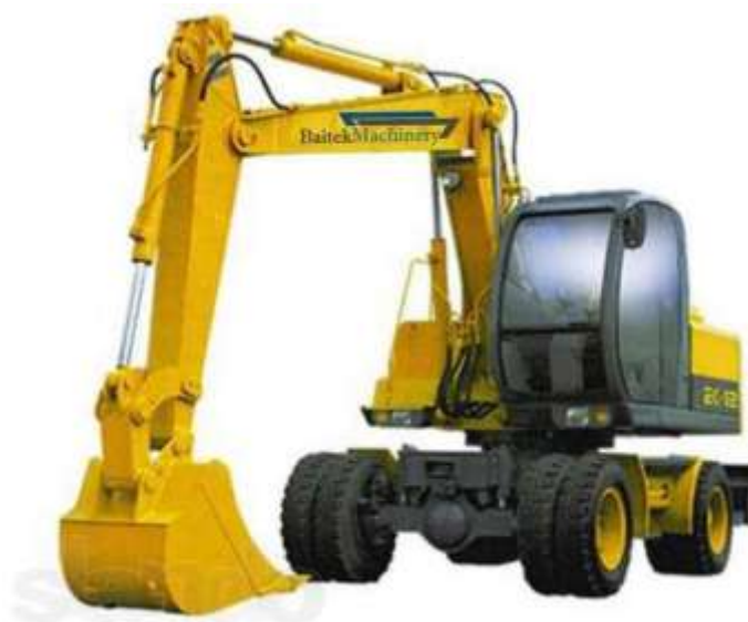
1-rasm. Ish jihozlari bikir osmali to'la aylanadigan bir cho'michli, teskari kurakli gidravlik ekskavatorlar
