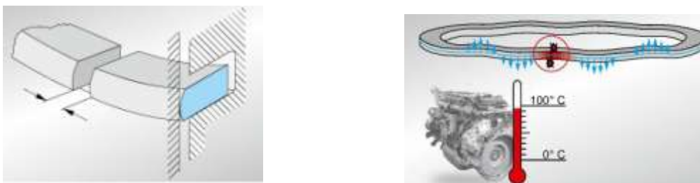
3-расм. Иссиқликни ҳалқа тирқишга таъсири.
