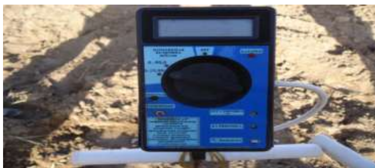
2-расм.Тупроқнинг шўрланиш даражаси ва температурасини далада аниқловчи “Прогрес -1Т” электр кондуктометр кўриниши.
