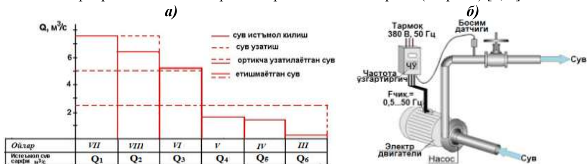
3-расм. Экинларнинг сув истеъмол қилиш ва насосларнинг сув узатиш поғонали графиги(а) ҳамда насоснинг айланишлар сонини ўзгартириш технологияси(б).
