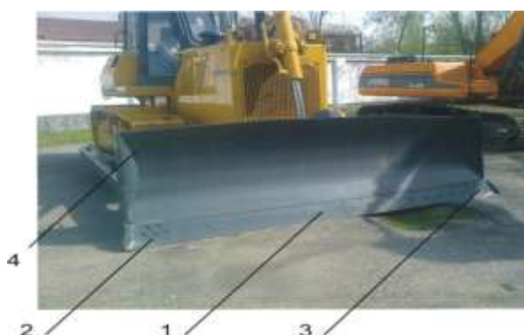
1-rasm. Buldozer ishchi jihozining joylashuvi:
