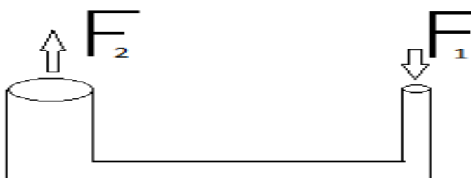
1-чизма. Гидравлик пресснинг схематик чизмаси.
