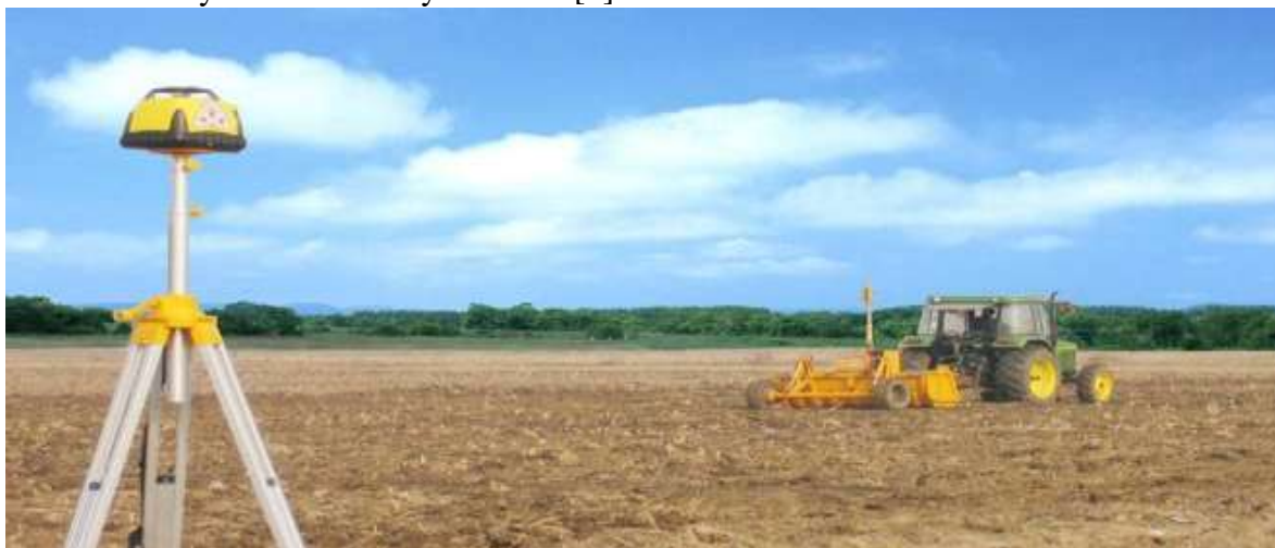
1-rasm. ARES 697 ATZ g'ildirakli traktor tirkamasida lazerli yer tekislash
