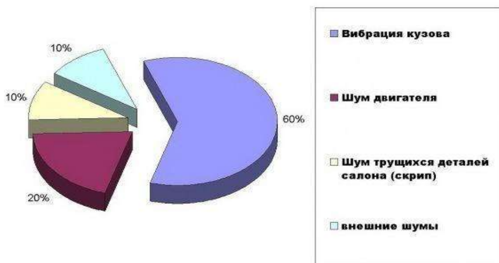
Рис. Источники вибрации и шума автомобиля.
