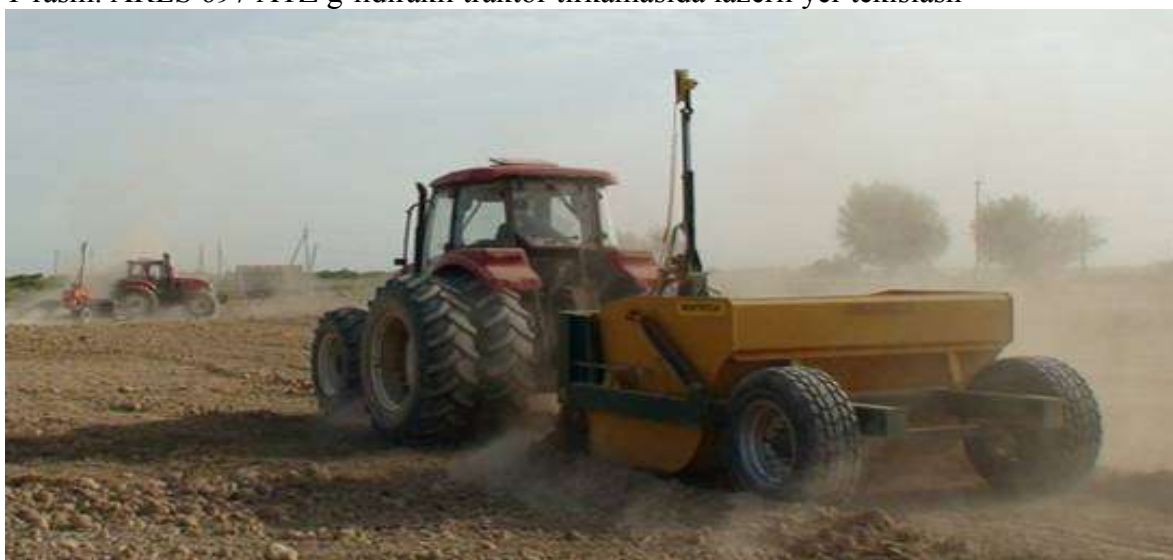
2-rasm. Xitoyning YTO-150 g'ildirakli traktori tirkamasidagi skreper bilan lazerli yer tekislash
