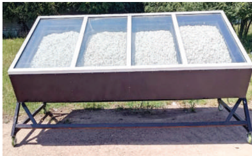
1-rasm. Quyosh energiyasi yordamida pillalar g'umbagini jonsizlantiruvchi qurilmaning takomillashtirilgan tajriba namunasini
