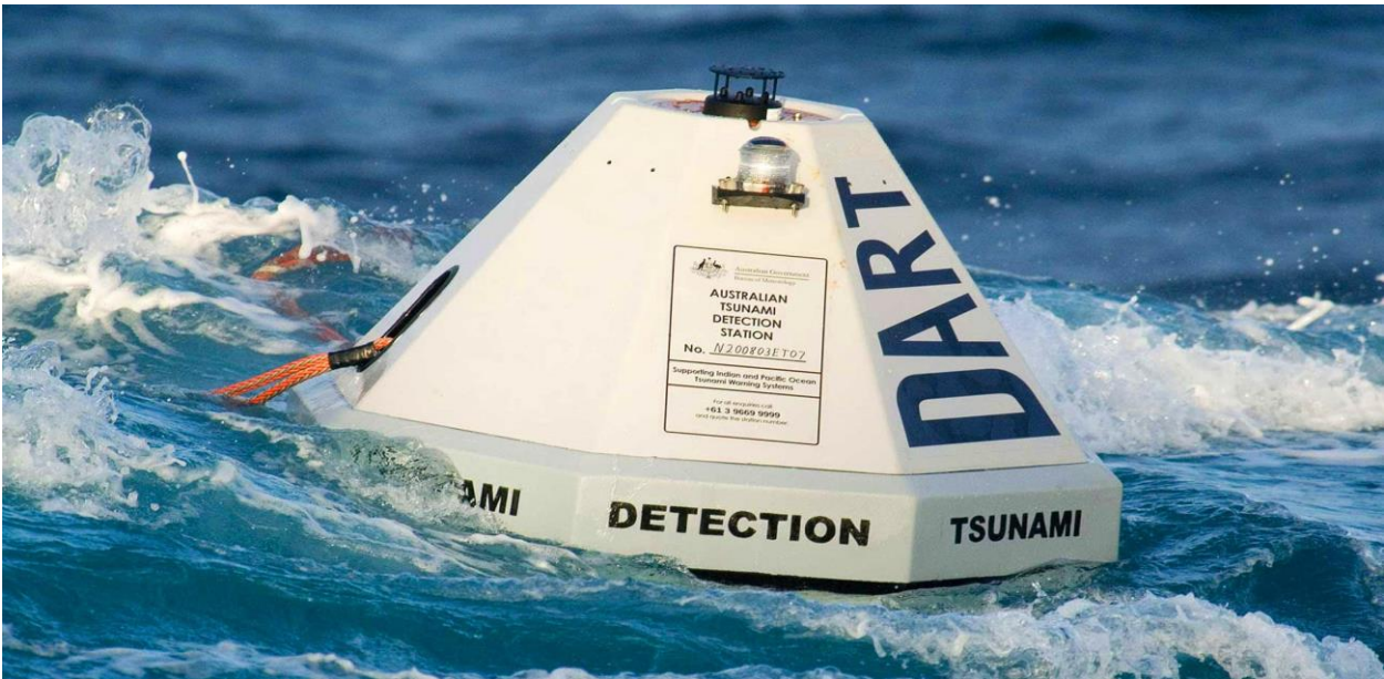
8.11-rasm. Sunamini aniqlash qurilmasi. https://kipmu.ru/tsunami .
