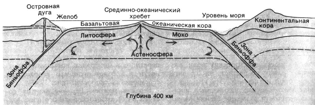
2.7-rasm. Yer qobig‘i va yuqori mantiya, shu jumladan qattiq litosferaning va plastik astenosferaning tuzilishi sxemasi: Benyoff zonasi, 400 km chuqurlik, Orol yoyi, nov (tarnov), O‘rtacha-oceanik cho‘qqisi, Bazaltli, Litosfera, Okean qobig‘i Astenosfera, Moxo, Dengiz sathi, Kontinental qobiq.
