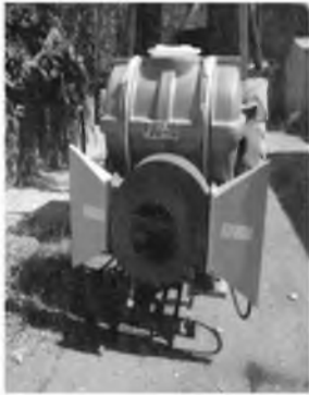
4-расм. Янги технология асосида боғларга кимёвий ишлов берадиган PJK'-10 универсал осма пуркагичнинг ишлаш жараёни.
